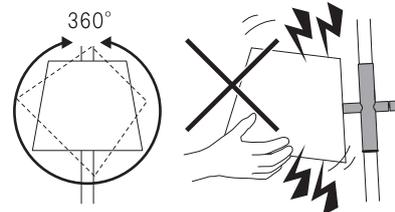
5. ソケットに電球を右回して取付けます。
