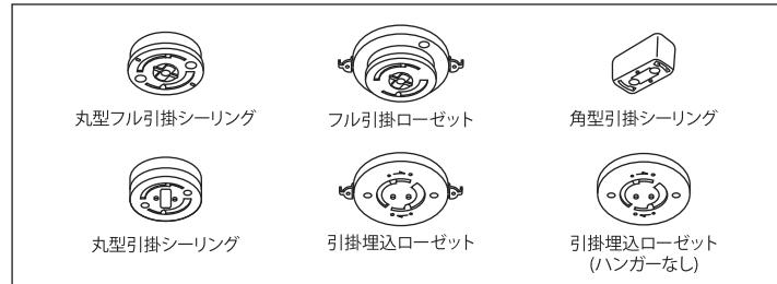
※以下のような場合は取付けができません。電気工事士の資格を持った電気工事店に依頼し、左記のいずれかを取付けの上ご使用ください。
